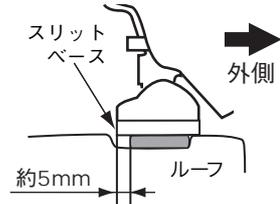
車両フロント側から見て、モールの端部とスリットベースの端部を合わせる。
