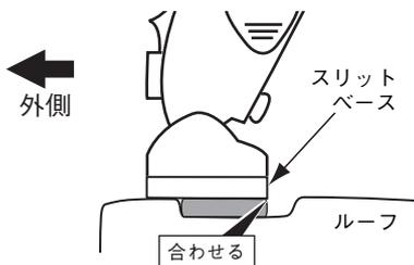
車両リア側から見て、モールの端部とスリットベースの端部を合わせる。
