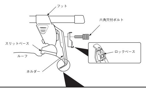
● 六角穴付ボルトは、ホルダーとルーフの隙間がなくなるまで締め付けてください。
