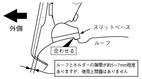
車両リア側から見て、ルーフの段差にスリットベースの段差を合わせる。
