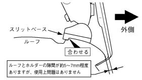
車両フロント側から見て、ルーフの段差にスリットベースの 段差を合わせる。
