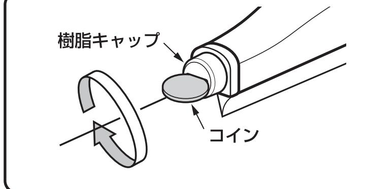
④ ゴムを最後まで押し込んだ後、コインなどで樹脂キャップを確実に締め、外れないことを確認してください。
