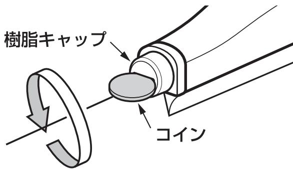
① スノーウィパー後端側の樹脂キャップを、コインなどで緩めて外してください。
