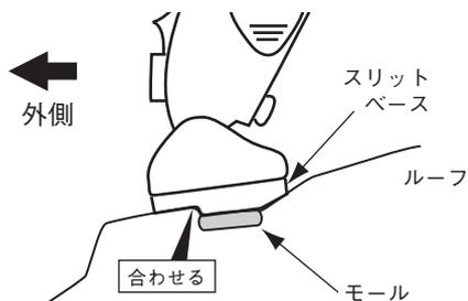
車両リア側から見て、ルーフの段差とスリットベースの段差を合わせる。
