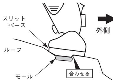
車両フロント側から見て、ルーフの段差とスリットベースの段差を合わせる。
