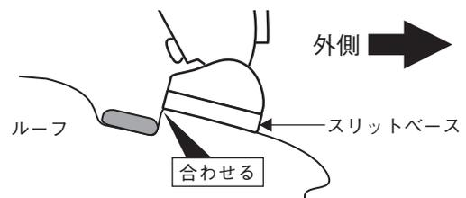
車両フロント側から見て、モールの端部にスリットベースの端部を合わせる。
