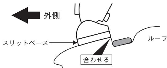
車両リア側から見て、モールの端部にスリットベースの端部を合わせる。
