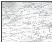
フローフォーミング施工前は、アルミ組織の密度が低い状態であるが、フローフォーミング施工後では、アルミ組織が鍛えながら引き伸ばされることで、緻密で均一の組織が生み出されています。
