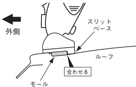
車両リア側から見て、モーラーの段差とスリットベースの段差を合わせる。
