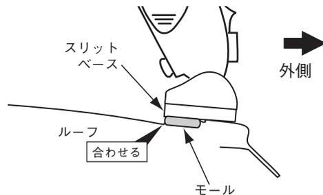
車両フロント側から見て、モーラーの端部とスリットベースの端部を合わせる。
