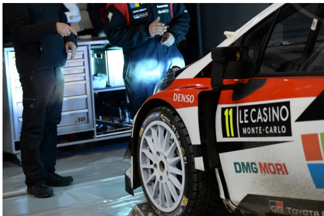
サービspark内でランプを照射して光軸調整
