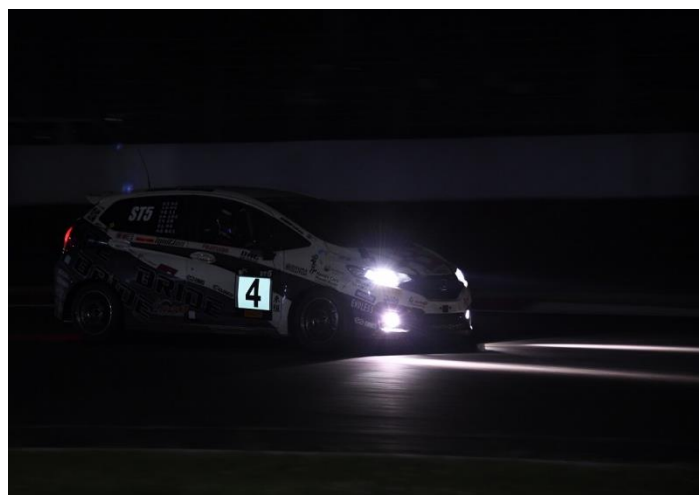
#4 純正 LED ヘッドライトを PIAA HID ヘッドライトでサポート
