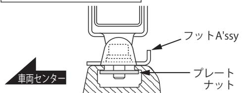
ベースプレートとプレートナットでダイレクトレールをはさみ込むように取り付けてください。その際、プレートナットがダイレクトレールに確実に固定されている事を確認してください。
