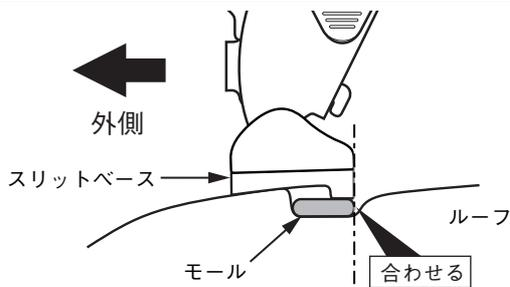
車両リア側から見て、モールの端部にスリットベースの端部を合わせる。
