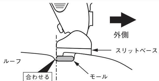
車両フロント側から見て、モールの端部にスリットベースの端部を合わせる。
