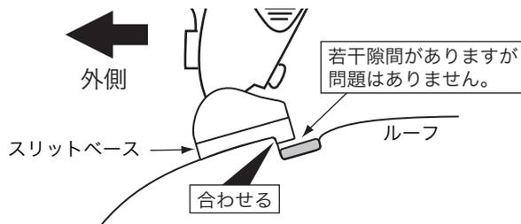
車両リア側から見て、ルーフの段差にスリットベースの段差を合わせる。
