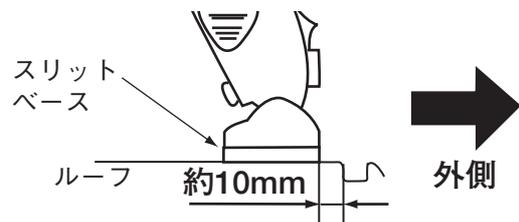
ルーフの段差とスリットベースの端部までの距離を約10mmに合わせる。
