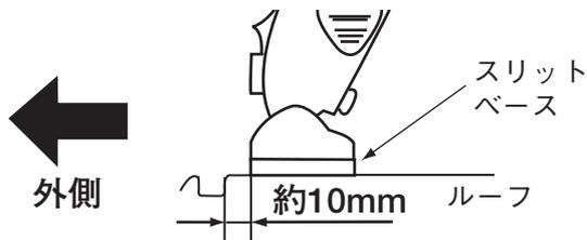
ルーフの段差とスリットベースの端部までの距離を約10mmに合わせる。
