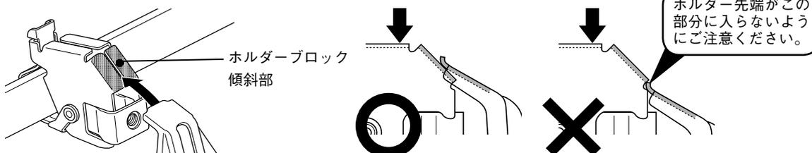
(3) 全てのホルダーを仮止めしたら、下記の手順で4ヶ所が均等に締まるよう、取付ボルトを六角レンチ：大と本製品に添付されている六角レンチ（部品⑨）にて締め付けてください。
