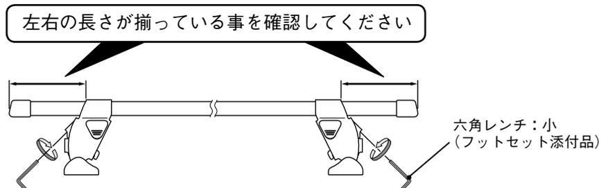
締め付けトルクは、約  $5\text{N}\cdot\text{m}$  を目安に締め付けてください。
