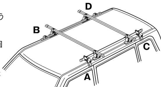
トルクレンチがない場合、締め付けの目安としては、下図の通り、スプリングワッシャーが完全につぶれてから2回転から3回転です。
