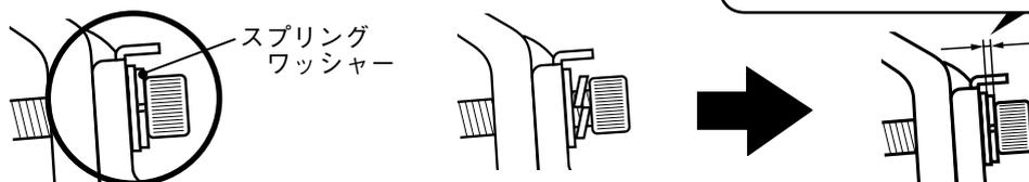
上記以上に締め込むと、車体のホルダー接触部分等に凹みや変形が発生し、車体が破損してしまう恐れがありますので、必ず、トルクレンチを用いて規定トルクで締め込むか、上記目安に従って、締め込んでください。
