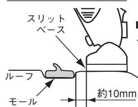
ルーフの段差からスリットベースの端部までの距離を約10mmに合わせる。
