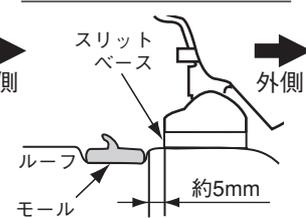
ルーフの段差からスリットベースの端部までの距離を約5mmに合わせる。
