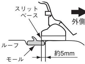
ルーフの段差からスリットベースの端部までの距離を約5mmに合わせる。
