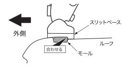
車両リア側から見て、モールの段差にスリットベースの段差を 今わせる
