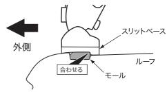
車両リア側から見て、モールの段差にスリットベースの段差を 合わせる。
