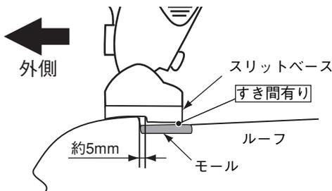
車両リア側から見て、ルーフの段差からスリットベースの段差までの距離を約5mmに合わせる。
