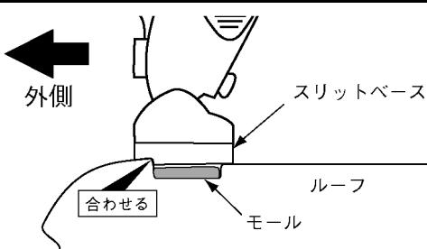
車両リア側から見て、ルーフの段差にスリットベースの段差を合わせる。
