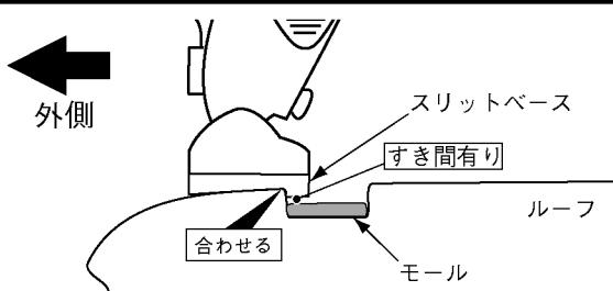
車両リア側から見て、ルーフの段差にスリットベースの段差を合わせる。
