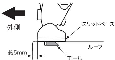
車両リア側から見て、ルーフの端部からスリットベースの端部までの距離を約5mmに合わせる。
