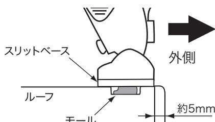
車両フロント側から見て、ルーフの端部からスリットベースの端部までの距離を約5mmに合わせる。
