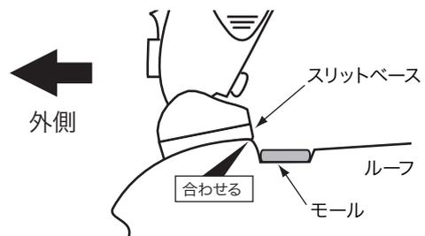
車両リア側から見て、ルーフの段差にスリットベースの端部を合わせる。
