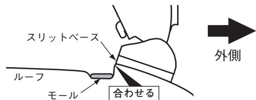
車両フロント側から見て、ルーフの段差にスリットベースの端部を合わせる。
