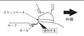
車両フロント側から見て、ルーフの段差にスリットベースの 端部を合わせる。
