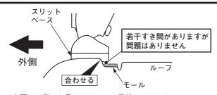
車両リア側から見て、ルーフの段差にスリットベースの 段差を合わせる。
