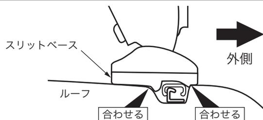
車両フロント側から見て、ルーフの段差にスリットベースの段差を合わせる。
