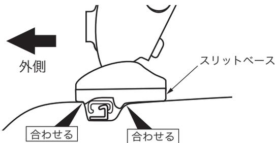
車両リア側から見て、ルーフの段差にスリットベースの段差を合わせる。
