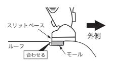
モールの端部にスリットベースに端部を合わせる。
