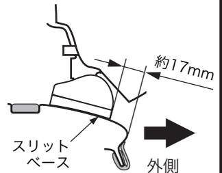
車両フロント側から見て、ルーフの端部からスリットベースの端部までの距離を約17mmに合わせる。
