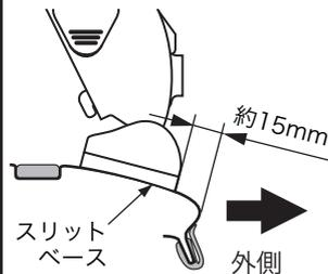
車両フロント側から見て、ルーフの端部からスリットベースの端部までの距離を約15mmに合わせる。
