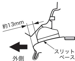
車両リア側から見て、ルーフの端部からスリットベースの端部までの距離を約13mmに合わせる。
