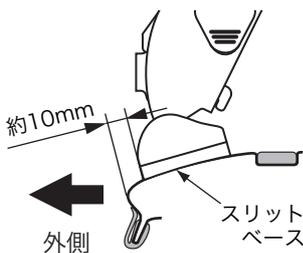
車両リア側から見て、ルーフの端部からスリットベースの端部までの距離を約10mmに合わせる。
