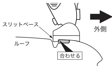
車両フロント側から見て、モールの端部にスリットベースの段差を合わせる。
