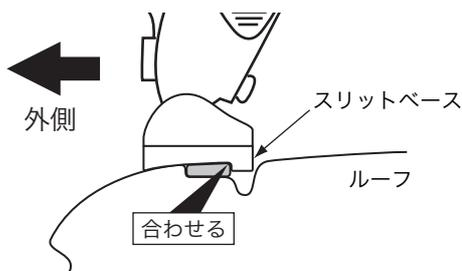
車両リア側から見て、モールの端部にスリットベースの段差を合わせる。
