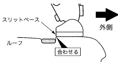
車両フロント側から見て、ルーフの段差にスリットベースの端部を合わせる。
