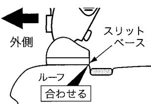
車両リア側から見て、ルーフの段差にスリットベースの端部を合わせる。
