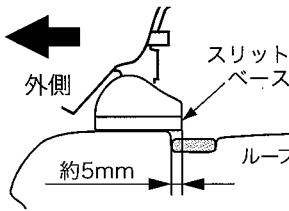
車両リア側から見て、ルーフの段差からスリットベースの端部までの距離を約5mmに合わせる。
