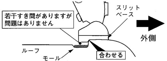
車両フロント側から見て、ルーフの段差にスリットベースの段差を合わせる。
