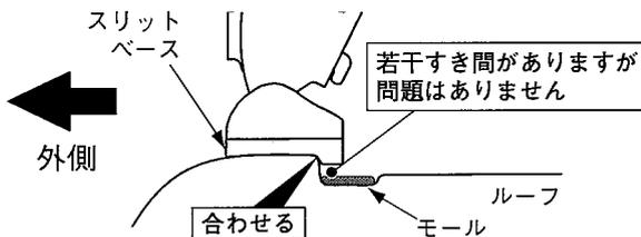
車両リア側から見て、ルーフの段差にスリットベースの段差を合わせる。
