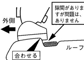
車両リア側から見てルーフの段差にスリットベースの段差を合わせる。
