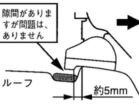
車両フロント側から見て、ルーフの段差からスリットベースの段差までの距離を約5mmに合わせる。
