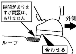
車両フロント側から見て、ルーフの段差にスリットベースの段差を合わせる。
