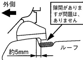
車両リア側から見てルーフの段差からスリットベースの段差までの距離を約5mmに合わせる。
