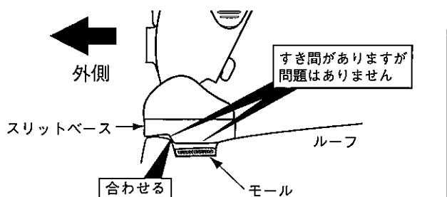
車両リア側から見て、ループの段差にスリットベースの段差を合わせる。
