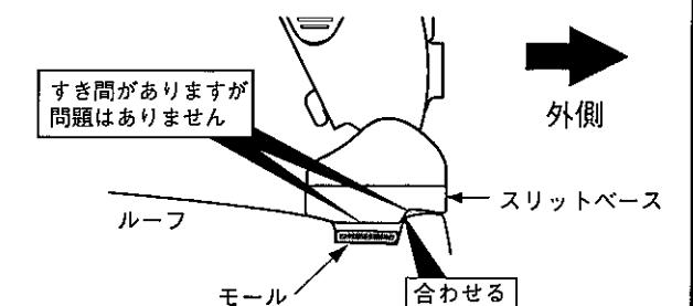
車両フロント側から見て、ループの段差にスリットベースの段差を合わせる。
