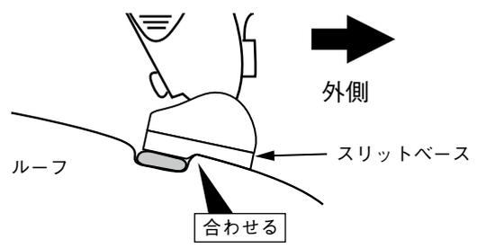
車両フロント側から見て、ルーフの段差にスリットベースの段差を合わせる。
