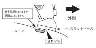
車両フロント側から見て、ルーフの段差にスリットベースの 段差を合わせる。
