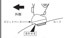
車両リア側から見て、ルーフの段差にスリットベースの段差 を合わせる。
