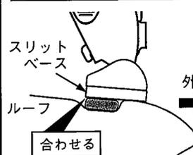
車両フロント側から見て、モールの端部にスリットベースの端部を合わせる。
