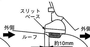
車両フロント側から見て、モールの端部からスリットベースの端部までの距離を約10mmに合わせる。
