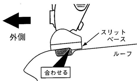
車両リア側から見て、モールの段差にスリットベースの段差を合わせる。
