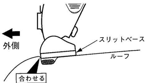
車両リア側から見て、ルーフの段差にスリットベースの端部を合わせる。
