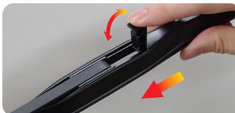
カバーを開き、ワイパーを矢印の方向にスライドさせ外します。
