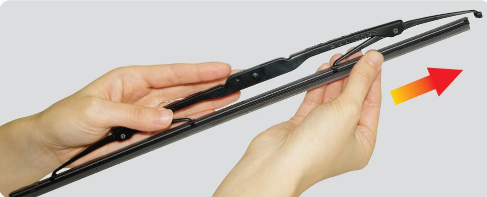
① ゴムを引き抜いた後端部から新しいゴムをワイパーのツメに通してください。※ストッパー穴がない側から通す
