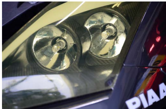
Hi, LowビームともにPIAA製LED Bulb 装着
