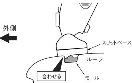
車両リア側から見て、ルーフの段差にスリットベースの段差を合わせる。
