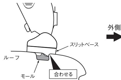
車両フロント側から見て、ルーフの段差にスリットベースの段差を合わせる。
