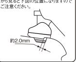
車両リア側から見て、ルーフの段差にスリットベースの段差を合わせる。 ※ システムキャリア、スキー専用キャリア共に合わせる位置は同様です。
