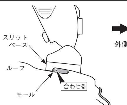
車両フロント側から見て、モールの段差とスリットベースの段差を合わせる。
