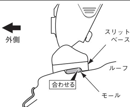
車両リア側から見て、モールの段差とスリットベースの段差を合わせる。
