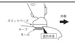
車両フロント側から見て、ルーフの段差にスリットベースの段差を合わせる。 ※ システムキャリア、スキー専用キャリア共に合わせる位置は同様です。
