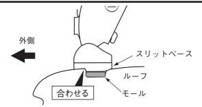
車両リア側から見て、ルーフの段差にスリットベースの段差を合わせる。 ※ システムキャリア、スキー専用キャリア共に合わせる位置は同様です。
