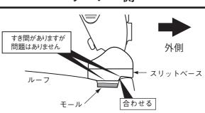
車両フロント側から見て、ルーフの段差にスリットベースの 段差を合わせる。
