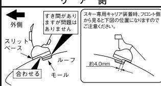
車両リア側から見て、ルーフの段差とスリットベースの段差を 合わせる。
