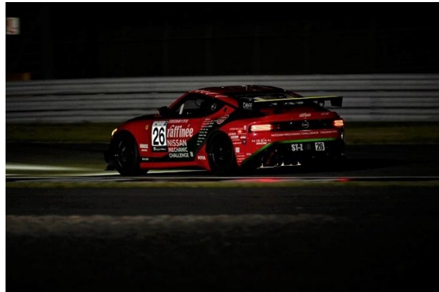
ST-Z クラス #26 rafinee 日産メカニックチャレンジ Z GT4 PIAA 製 LED バールランプをグリルにインストール このクラスはヘッドライトを黄色にするレギュレーションによって、光量が落ちた分を LED バールランプでサポート！
